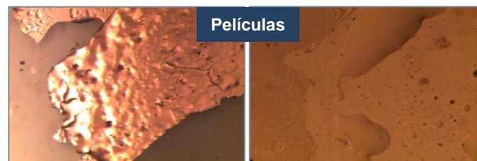
Ocorre também a formação de tubos de cobre multicamadas tipo pergaminho para os filmes com espessuras maiores que 0,5  $\mu\text{m}$ , com padrão reprodutível.
