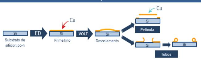
Para a obtenção das películas e tubos de cobre, os filmes foram submetidos a voltametrias cíclicas, utilizando uma solução aquosa de  $\text{Na}_2\text{SO}_4$  com concentração de 1 M.
